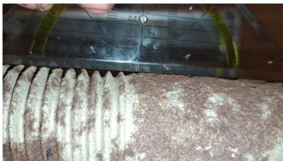
Figuur 8.2 Diameter gladde stang is gelijk aan diameter uitwendig schroefdraad.
