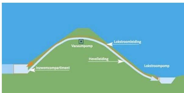
Figuur 2.7 - Links: Typische doorsnede van een hevel-vispassage. Rechts: Vishevel bij Berghem, Noord-Brabant (wikipedia)
